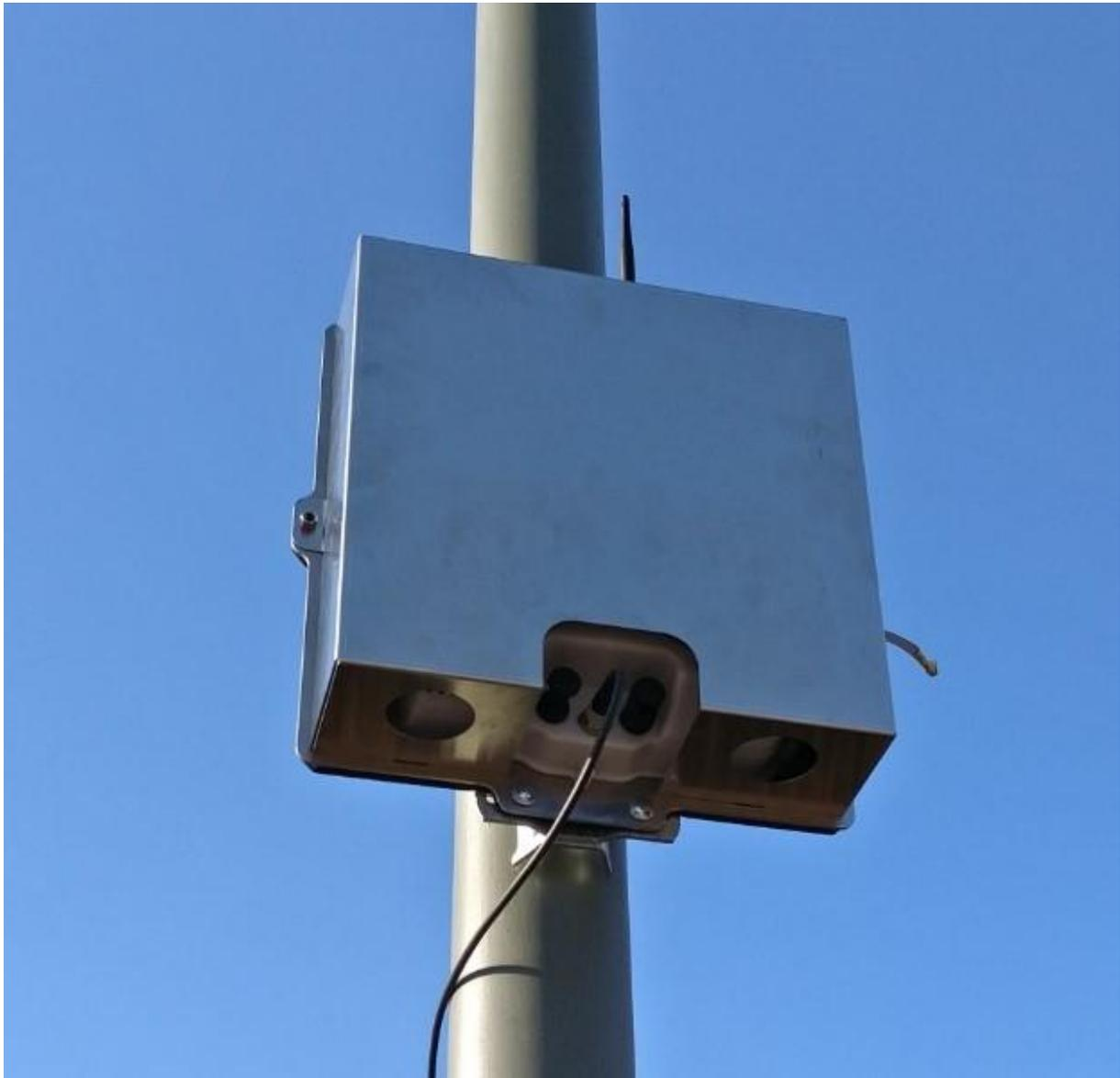
*Abbildung 1: Hawa Dawa Messgerät montiert an einem Lichtmast*
