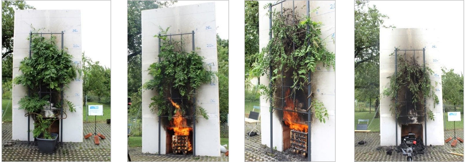
Abb. 16 bis 19: Brandversuch FA_BV_Blauregen
