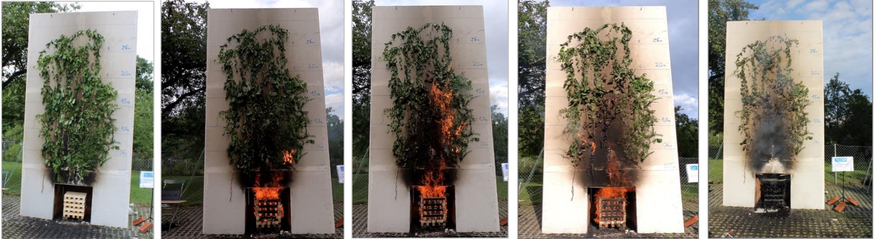
Abb. 28 bis 32: Brandversuch FA_BV_Kiwi, Stauden und Kräuter
