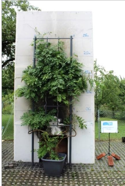
Abb. 20 und 21: Brandversuch FA_BV_Blauregen (links), Projekt BeRTA in Wien, GRÜNSTATTGRAU (rechts)
